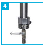
4 油漆过滤器与回流装置 Material Filter and Recirculation
